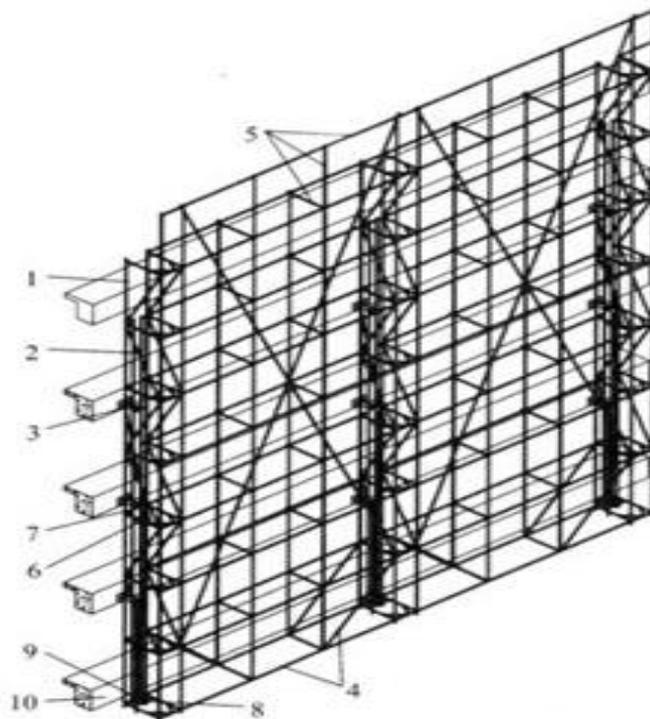
图 4.6.1-2 空间桁架式主框架的架体示意图
