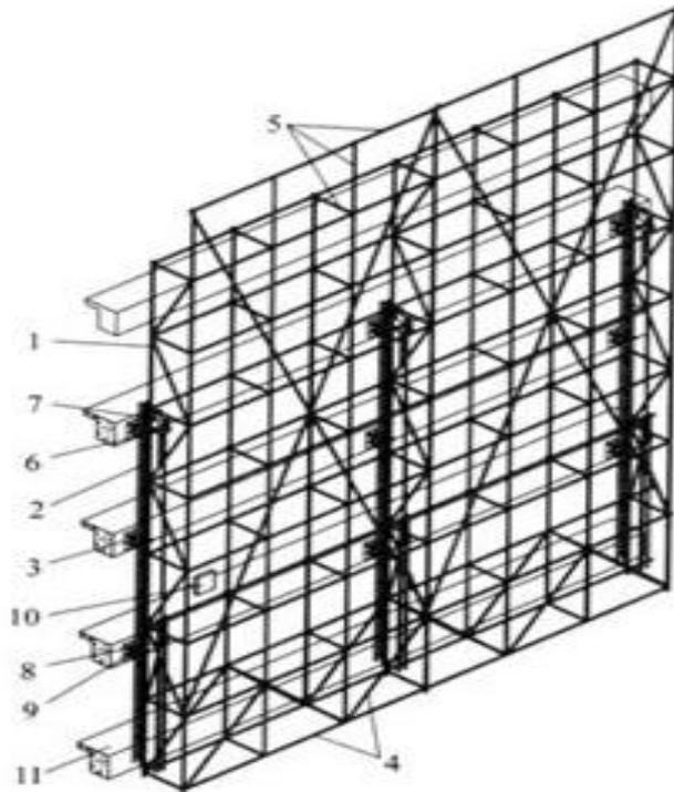
图 4.6.1-1 单片式主框架的架体示意图
